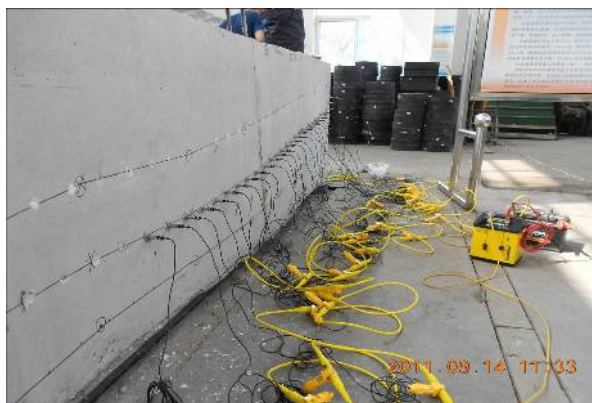
SUMMIT II Compact HSを用いたコンクリート調査
